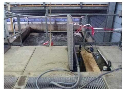
Cellule Biofor® test avec instrumentation
